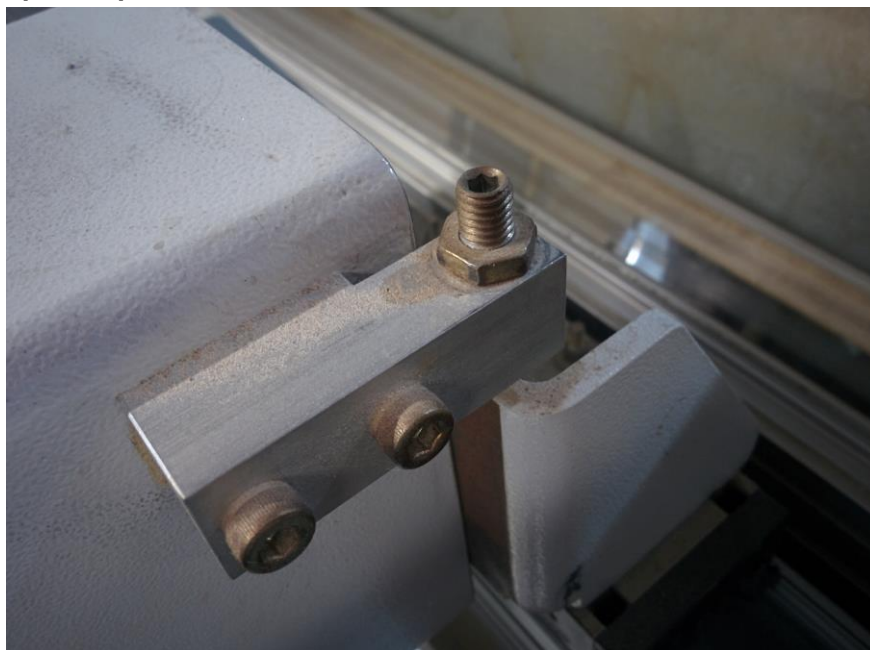
Рис.8 Настройка угла наклона ножа рекоатера
