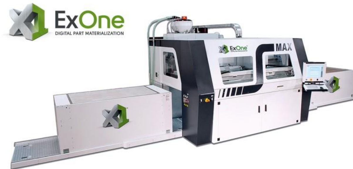
Рис.2 Промышленный принтер ExOne S-MAX
